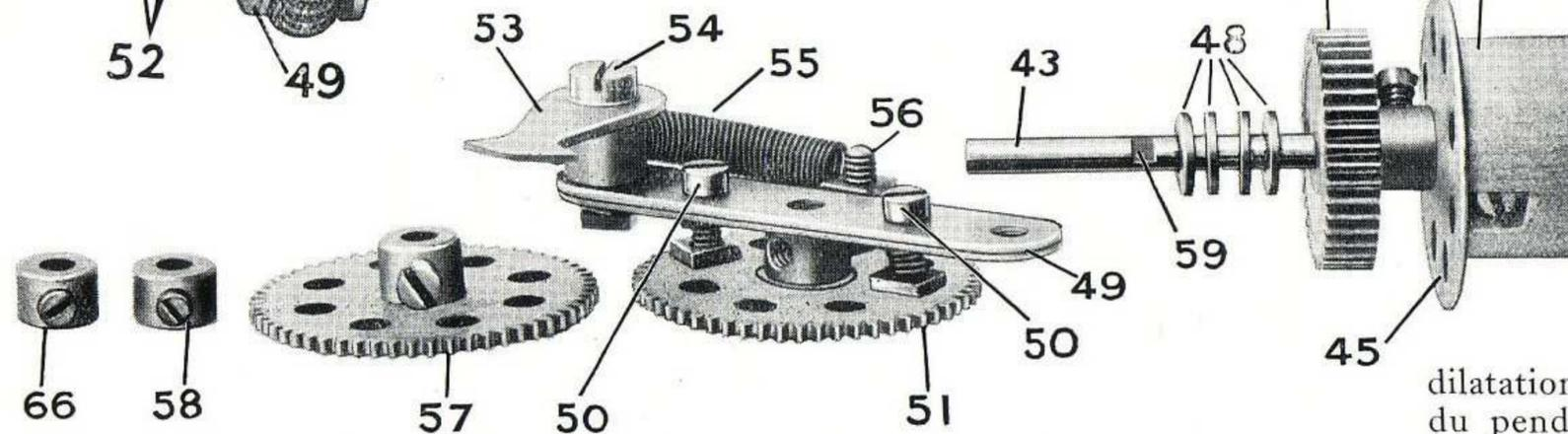
Fig. 6. Pièces constituant le mécanisme de remontage.
